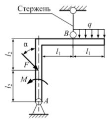
2. Для стального стержня, нагруженного системой сил F = 55 кH, определить нормальные силы N, нормальные напряжения сигма, если диаметр d = 25 мм. Проверить стержень на прочность, если допускаемые напряжения [сигма] = 150 МПа. Построить эпюры нормальных сил N и нормальных напряжений сигма.
